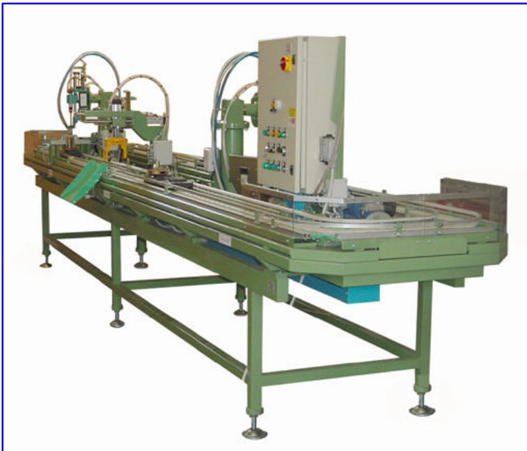
6.3 Macchina di montaggio serrature con dettaglio
